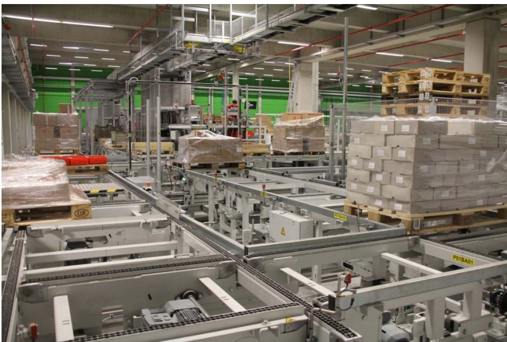
Bei der Ausführung stationärer Fördertechnik lohnt es sich, eine Leistungsreserve vorzusehen ©Unitechnik
