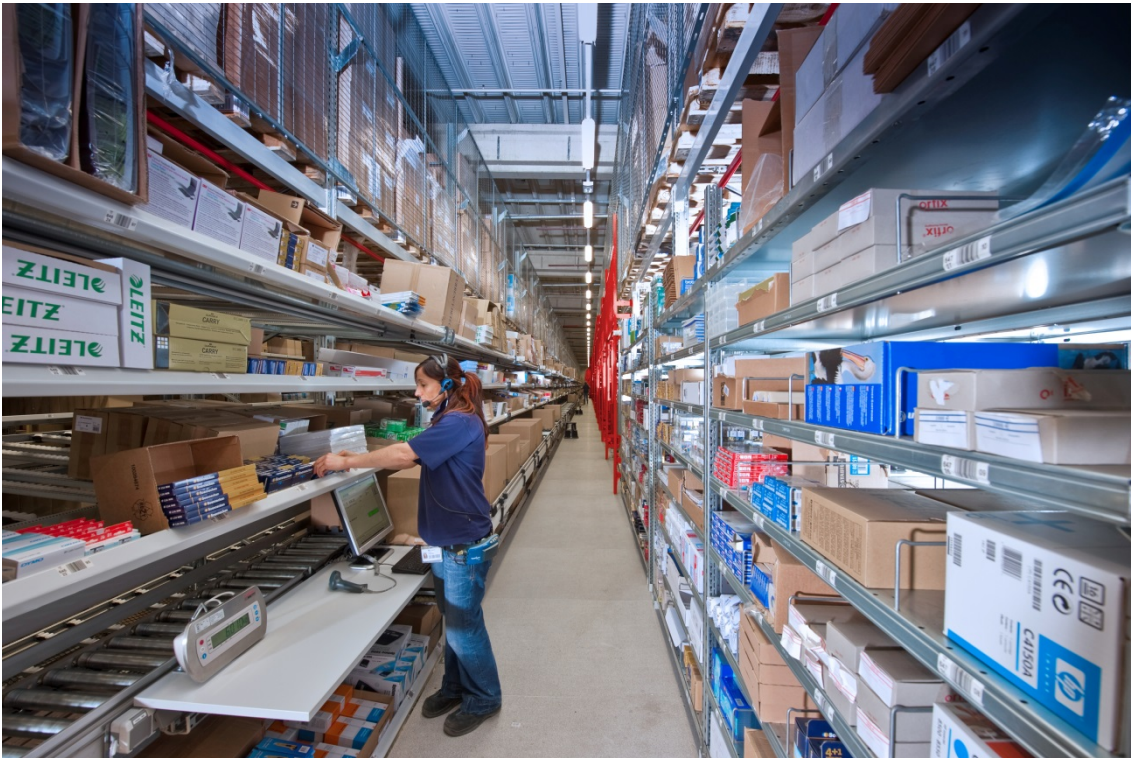
Person zur Ware Kommissionierung mit Pick-by-voice, Pick&Pack und Kontrollwiegung ©Unitechnik
