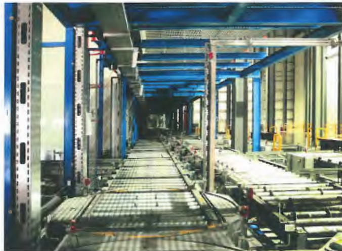
Zwischen den beiden Hochregallagern befindet sich die Kommissionierzone, die über eine Palettenfördertechnik versorgt wird
