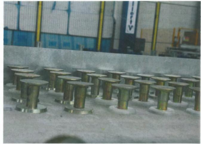
Bereitstellung von Gewindehülsen mit Hilfsmagneten
