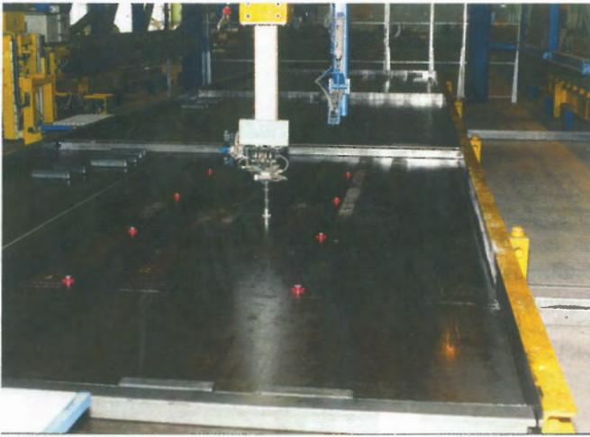
Insertroboter beim Setzen von Gewindehülsen
