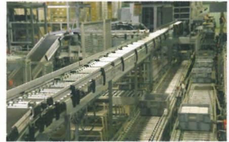
**3** Durch die Trennung der Materialflüsse für Paletten- und Behälterlager werden diese beiden Lagerbereiche deutlich schneller und effizienter versorgt (Bilder: Unitechnik)
