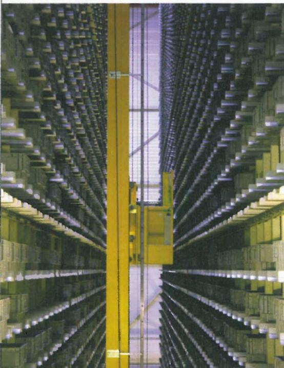
**1** Etwa drei Viertel seiner Artikel bevorratet Eaton in einem automatischen Behälterlager
