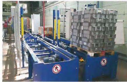
**2** Zwischen Wareneingang und Kommissionierung konnten die Prozesse u. a. durch den Einsatz neuer Palettenfördertechnik deutlich entzerrt werden
